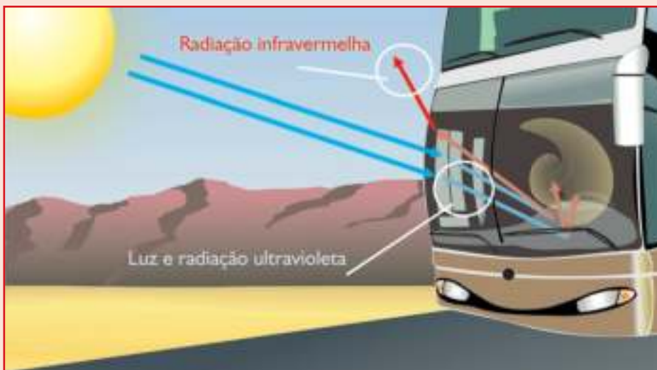
Figura 1.6. Uma simulação do efeito estufa: a ação da radiação solar sobre um ônibus com vidros fechados.
